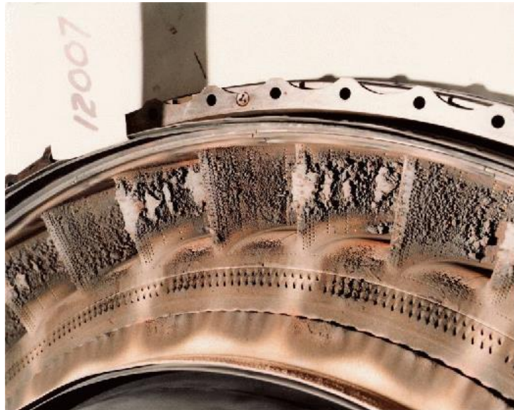
Pevná část proudového motoru po průletu sopečným mrakem
